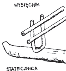
Il. 12. Łączenie wsięgnika ze statecznicą, typ Moluki (szczegóły wiązania pominięto)
