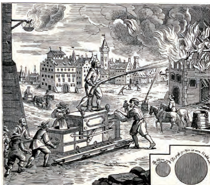
Fot. 2. Przykład pompy na saniach zaprojektowanej i wykonanej przez Hansa Hautscha (1661)
